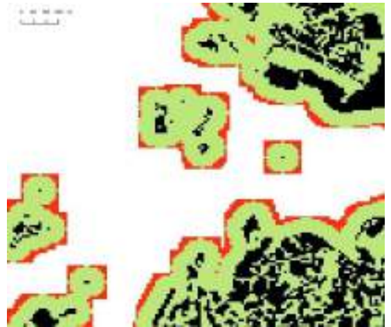
Figura 165. Dettaglio dell'elaborazione della distanza di 60 metri dal suolo consumato (in nero il suolo consumato, in verde il buffer circolare del nuovo metodo, in arancione il buffer quadrato del precedente metodo). Fonte: elaborazioni ISPRA su cartografia SNPA
