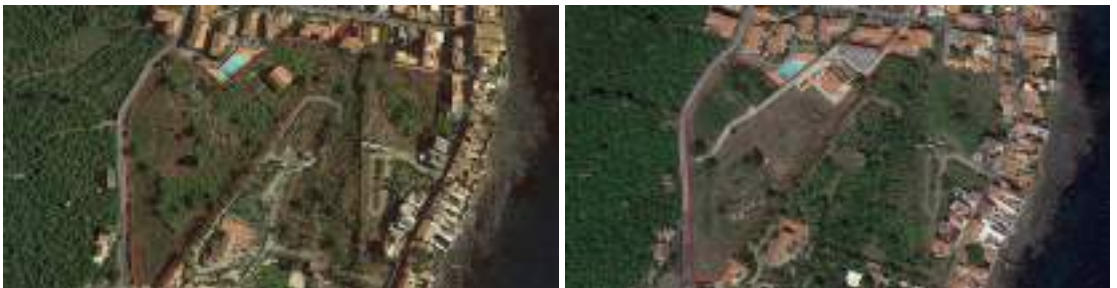
Figura 268. Comune di Acireale (prov. Catania): area inizialmente interessata da edificazione dal 2010 (circa 450m 2 ), ultimata tra il 2020 ed il 2021 con ulteriore realizzazione di ampia area impermeabilizzata e strada d'accesso. È presente un'area di cantiere con terrazzamenti e sbancamenti per un totale di oltre 2 ettari. Fonte: elaborazioni ARPA Sicilia su immagini Google Earth
