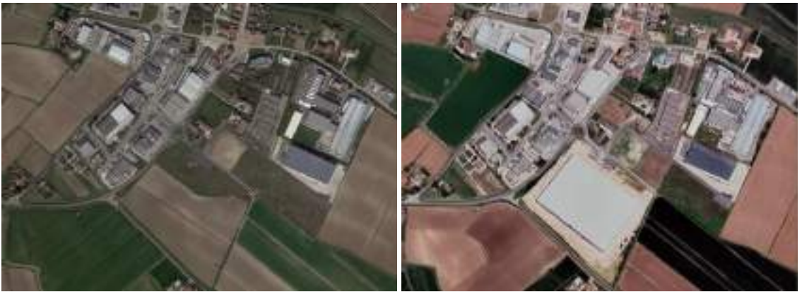
Figura 99. Consumo di suolo nel Comune di Castelbelforte in provincia di Mantova tra il 2020 e il 2021 per attività di ampliamento di un insediamento produttivo, per una superficie complessiva di 4,6 ettari (di cui 4 ettari l'edificio, codice 111)
